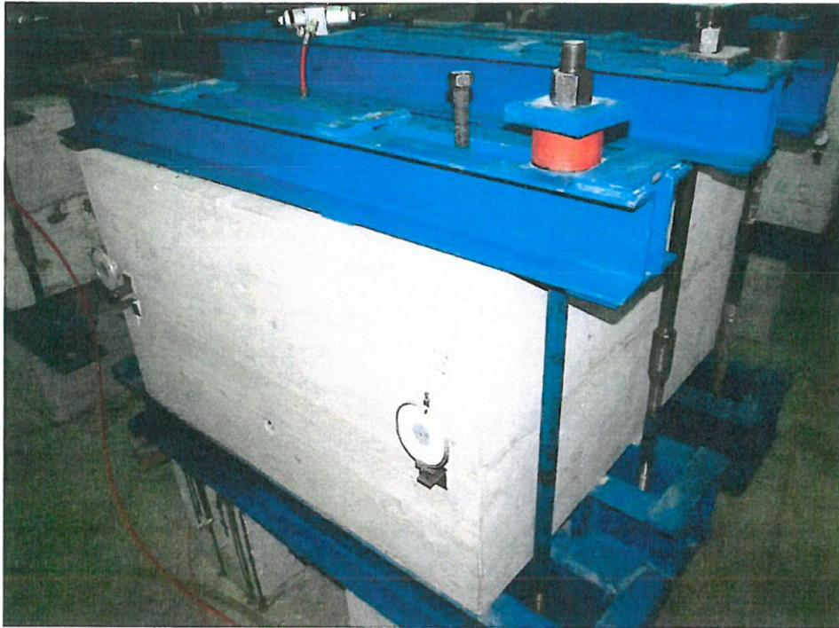
Bild 5: Prüfkörper während der Druckwasserbeanspruchung
