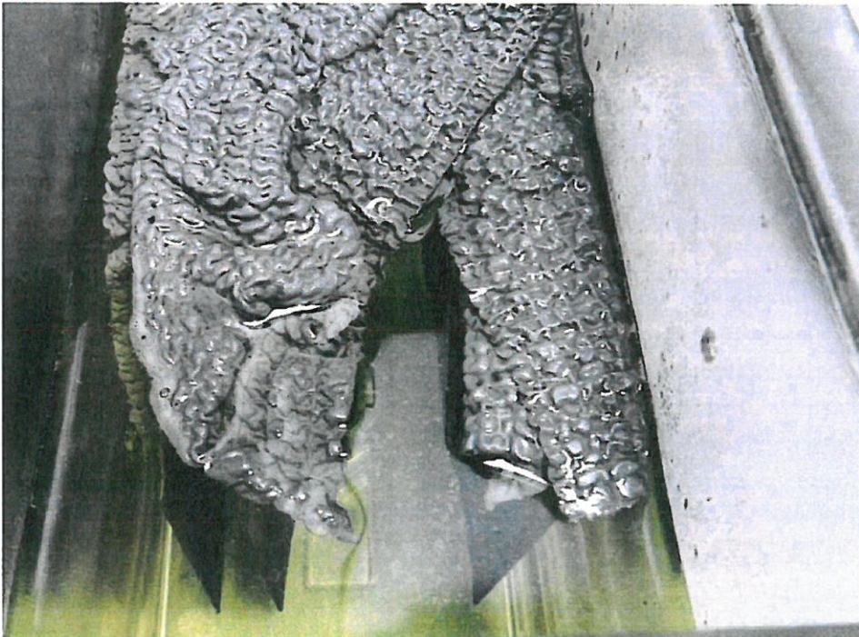
Bild 8 abgelöste Beschichtung der in Prüfflüssigkeit S eingelagerten Fugenbleche
