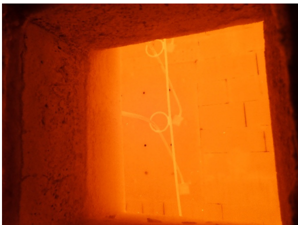
Bild A3-17 Blick in den Brandraum zum Ende der Brandprüfung, rechte Seite – 244. Minute
